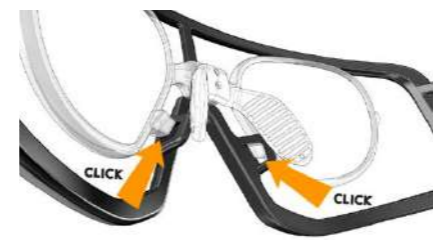
4 premere per agganciare il clip push to assemble the clip
